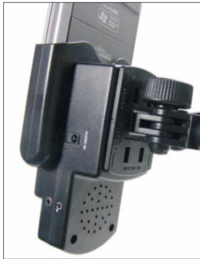
Der Lautsprecher befindet sich an der Halter-Rückseite und strahlt seinen Klang daher in die falsche Richtung. Dadurch wird das Audiosignal etwas dumpf.
